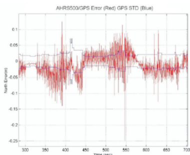
Rys. 11. Błąd północny AHRS500/GPS
