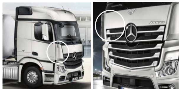
Rys. 3. Przykładowy deflektor powietrzny, stosowany seryjnie w ciągniku siodłowym Mercedes Actros, [13]
