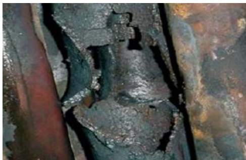
Rys. 1. Uszkodzenia rur kotłowych w wyniku krótkotrwałego przegrzania
