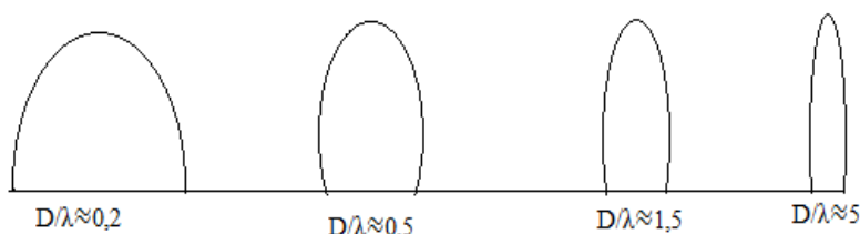
Rys. 4. Rodzaje rozchodzenia się fal ultradźwiękowych przy różnych stosunkach średnicy źródła drgań do długości fali
