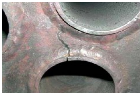
Rys. 2. Uszkodzenie rur kotłowych w wyniku długotrwałego przegrzania
