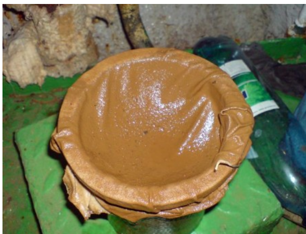
Rys. 6. Widok zanieczyszczzonego wkładu filtra wody zasilającej Fig. 6. A foul filter pack of supply water
