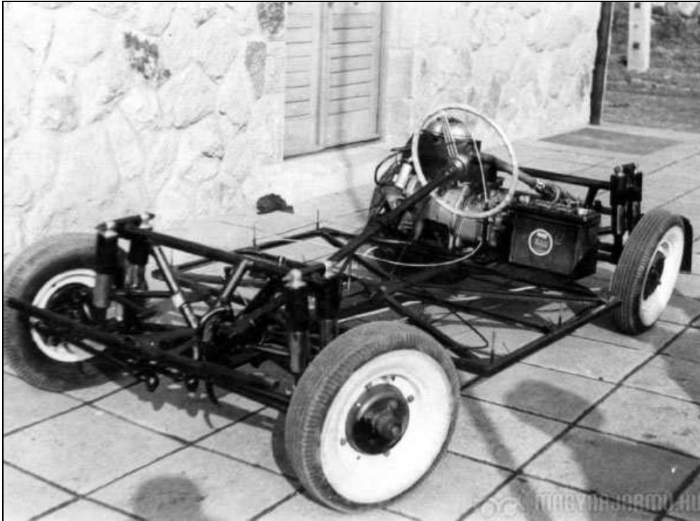
Fot. 30. Podwozie, układ kierowniczy i silnik Festivala [27]
