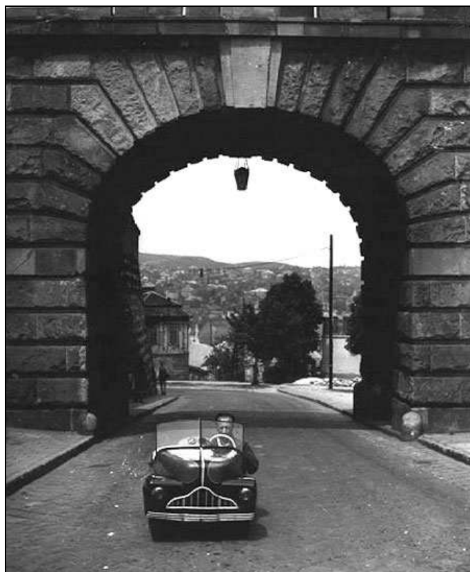
Fot. 4. Większy pojazd miał silnik 250 cm 3 . Zdjęcie wykonano na zamku w Budzie [3]
