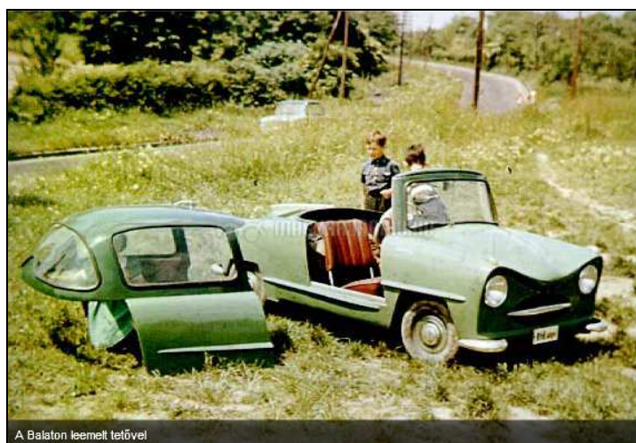
Fot. 22. Samochód Balaton po zdjęciu górnej części nadwozia (dachu) [19]
