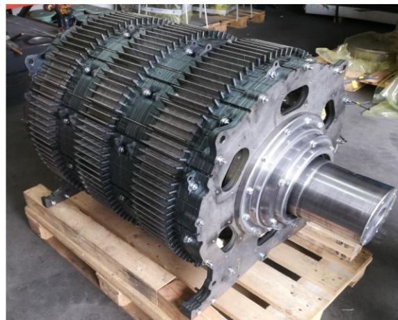
Rys. 8. Widok złożonego hydrogeneratora przed malowaniem
