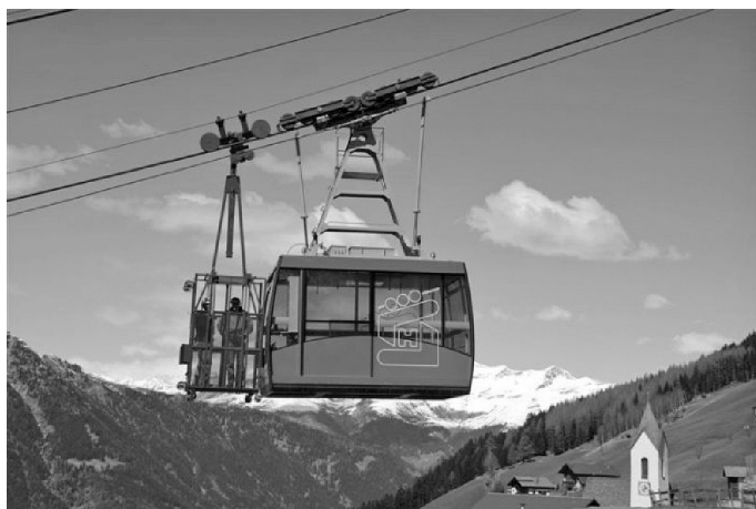
Rys. 2. Ewakuacja przy użyciu pojazdu ratunkowego [7]
