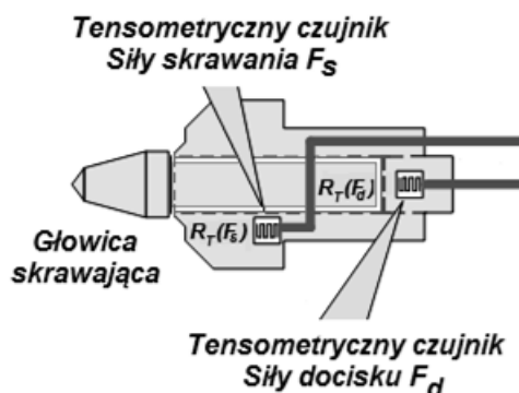
Rys. 4.13 Głowica pomiarowa przyrządu POU-BW/01-WAP z mostkami tensometrycznymi
