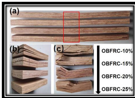
Rys 2. Obrazowe wyniki testu wytrzymałości mechanicznej kompozytów wzmocnionych włóknem bambusowym w zależności od siły nacisku [26].
