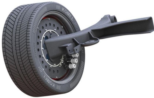
Rys. 2. Model 3D zamontowanego silnika a) silnik bez felgi b) silnik z zamontowaną felgą oraz oponą c) silnik z zamontowaną felgą oraz oponą - widok od strony zasilania
