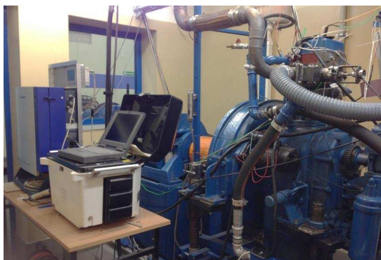
Rys. 3. Widok silnika badawczego wraz z zamontowaną przepustnicą oraz aparaturą pomiarową
