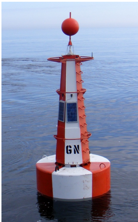
Rys. 4. Pława typu PM-2 (GN) źródło: http://ais.strefa.pl/i/GD.jpg
