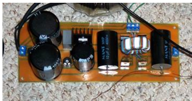
Rys. 7. Mostek pośredni, sterujący pracą tranzystorów mocy
