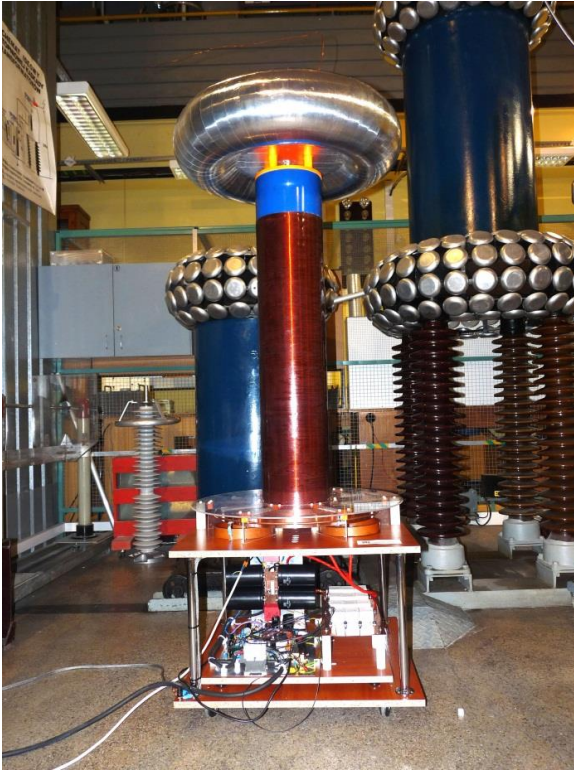
Rys. 8. „Grający” transformator Tesli w Laboratorium Wysokich Napięć Katedry Elektrotechniki i Elektroenergetyki AGH
