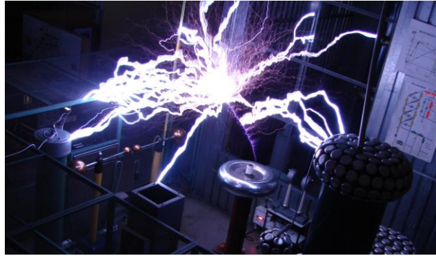
Rys. 9. Przykład wyładowań elektrycznych generowanych przez „grający” transformator Tesli w polu probierczym Laboratorium Wysokich Napięć KEE AGH
