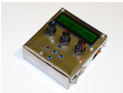
Rys. 5. Autonomiczny sterownik mikroprocesorowy z kartą pamięci plików standardu MIDI , zbudowany na mikrokontrolerze ATmega2560
