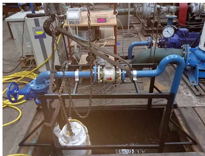
Rys. 13. Laboratorium Maszyn i Urządzeń Hydraulicznych Politechniki Śląskiej. Stanowisko do badań pomp zatapialnych
