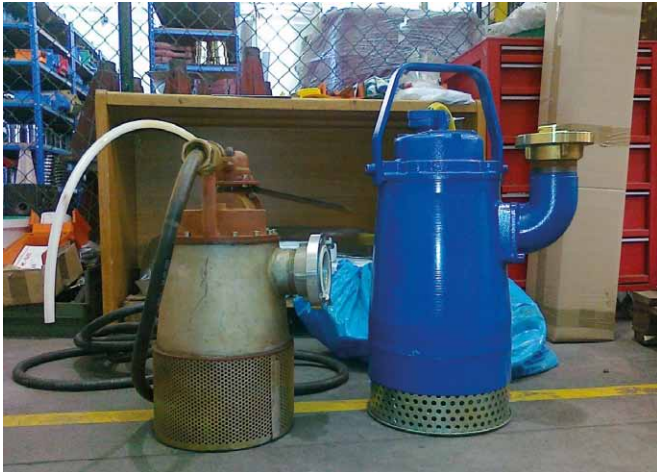
Rys. 19. Widok pomp prototypowej i pompy innego znanego producenta, mających silniki elektryczne o tej samej mocy 2,2 kW
