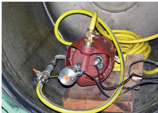
Rys. 17. Agregat pompowy w komorze zabezpieczającej przed ewentualnymi skutkami wywołanego w jego silniku wybuchu gazu w ramach badań ATEX wg normy PN-EN 60079-0:2009
