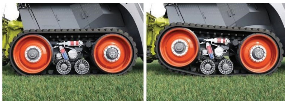
Rys. 8. Budowa i działanie systemu gąsienicowego Terra Trac [15]
