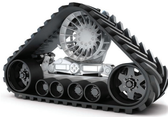
Rys. 3. Zamiennik ogumienia wielkogabarytowego — system łańcuchowy typu delta [7]
