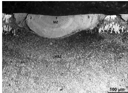
Fig. 5. Microstructure of borochromized C45 steel modified by laser Rys. 5. Mikrostruktura stali C45 borochromowanej modyfikowanej laserem
