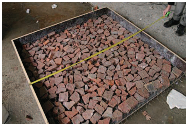
Rys. 3. Ułożenie cegieł w formach
