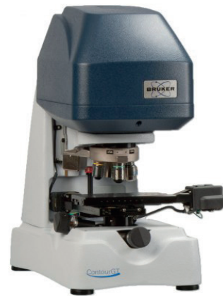
Fig. 3 . Optical profilometer Contour GT Bruker
