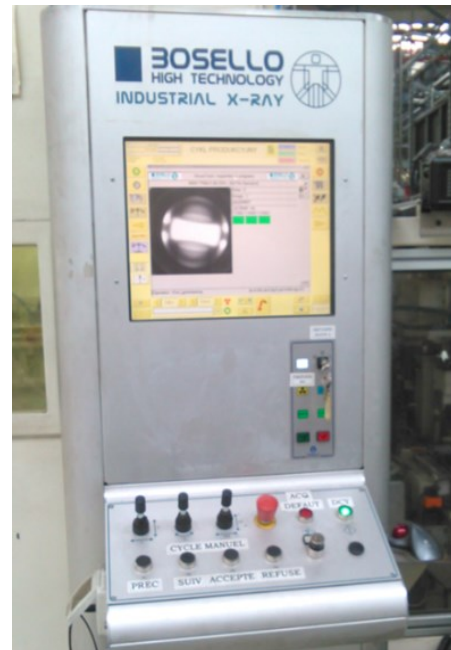
Rys. 1. Stanowisko do badań penetracyjnych: a) widok ogólny, b) widok panelu sterującego w trybie produkcyjnym aparatu do badań radiograficznych BOSELLO HIGH TECHNOLOGY INDUSTRIAL X-RAY
