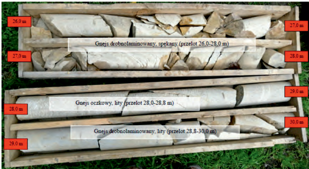
Rys. 5. Fragment rdzenia z otworu wiertniczego 5D (26,0 - 30,0 m). Lokalizacja fragmentu na profilu otworu patrz Rys. 4 Fig. 5. Section of the core from 5D borehole (26.0 - 30.0 m). Location of the presented section see Fig. 4
