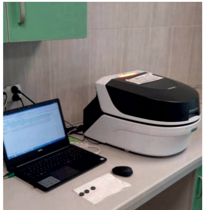
Rys. 8. Spektrometr Shimadzu EDX-7000 Fig. 8. Shimadzu EDX-700 spectrometer
