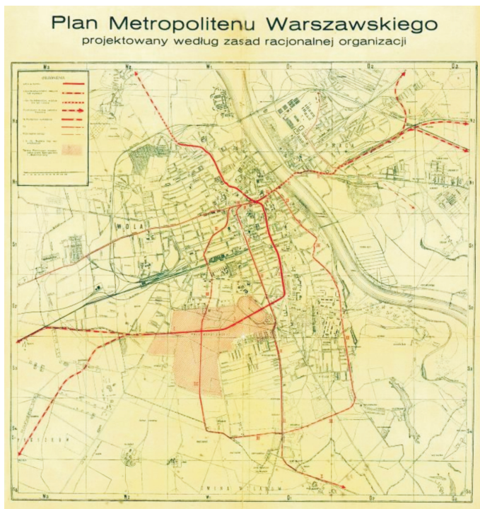
Rys. 1. Plan rozbudowy metra z 1925 r. wraz z kolejowymi liniami podmiejskimi, z którymi miało być połączone
