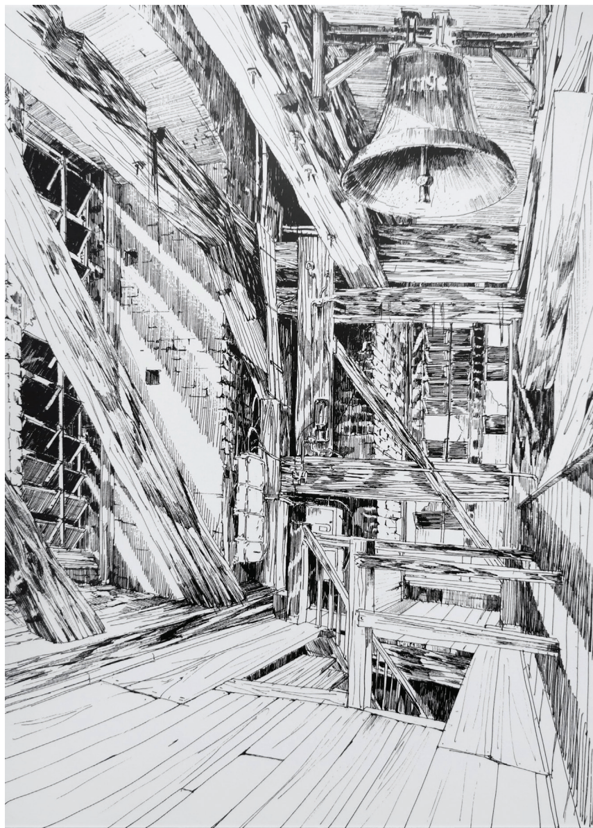
Rys. 3. Wnętrze zabytkowej wieży kościoła farnego pw. NMP w Chełmnie – inwentaryzacja rysunkowa konstrukcji drewnianej, rys. R. Gostkiewicz, źródło: fot. aut.
