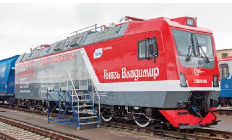
Dwusystemowa lokomotywa elektryczna serii 2EW120 (3 kVDC, 25 kV 50 Hz) wyprodukowana we współpracy z koncernem Bombardier dla RZD, Szczerbinka k. Moskwy (5.09.2015 r.). Fot. D. Szczukin
