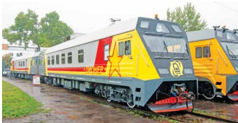
Spalinowy zespół trakcyjny „Pionier”, zbudowany przez firmę Twema do kontroli stanu infrastruktury, Szczerbinka k. Moskwy (5.09.2015 r.). Fot. D. Szczukin
