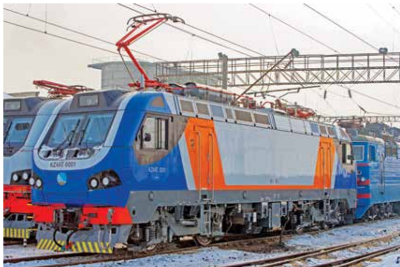
Lokomotywa elektryczna serii KZ4AT-0001 (25 kV 50 Hz) kolei kazachskich, zbudowana przez Alstom i Transmaszholding, podczas postoju na stacji Szu, Kazachstan (30.11.2014 r.). Fot. M. Utkin
