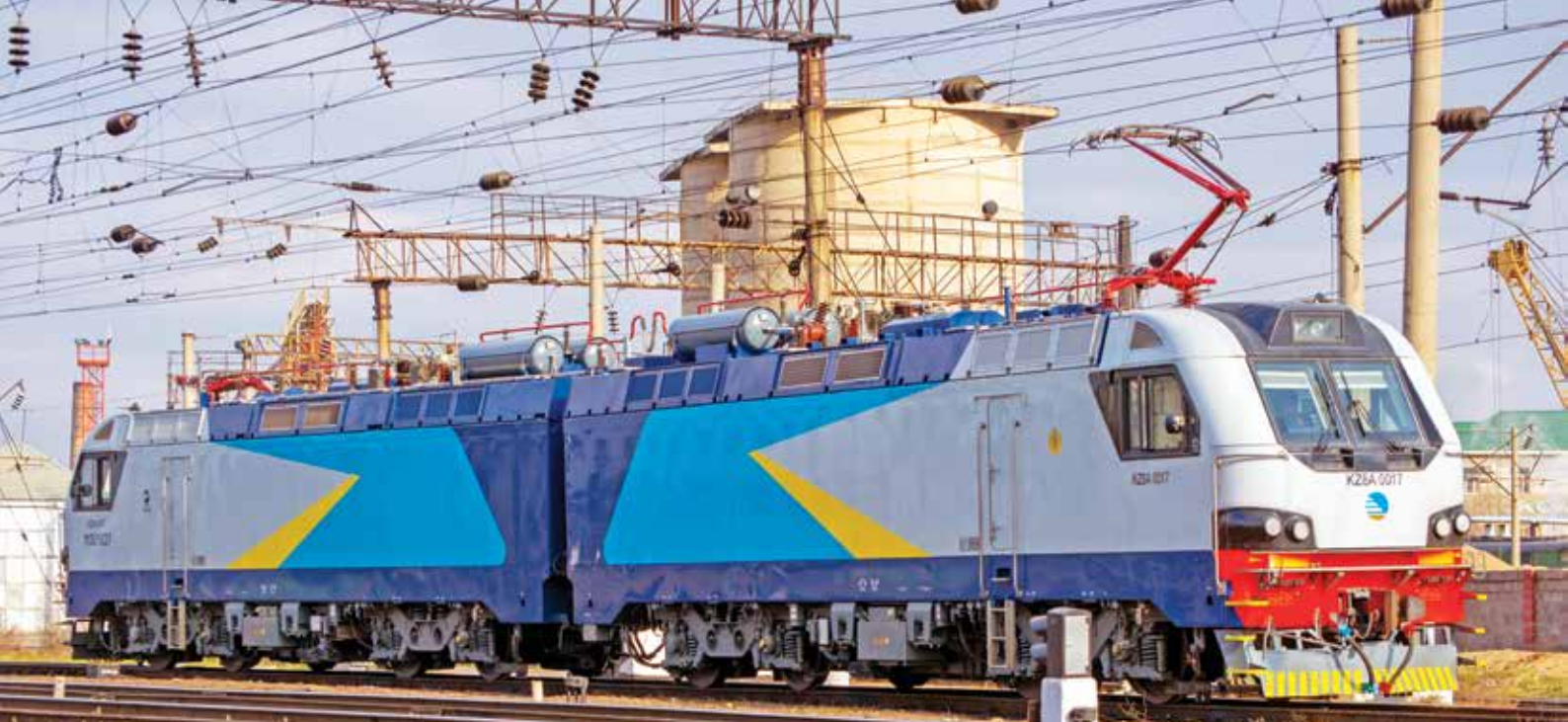
Lokomotywa elektryczna serii KZ8A-0017 (25 kV/50 Hz) kolei kazachskich zbudowana przez Alstom i Transmaszholding; podczas postoju na stacji Szu, Kazachstan (22.11.2014 r.). Fot. M. Utkin
