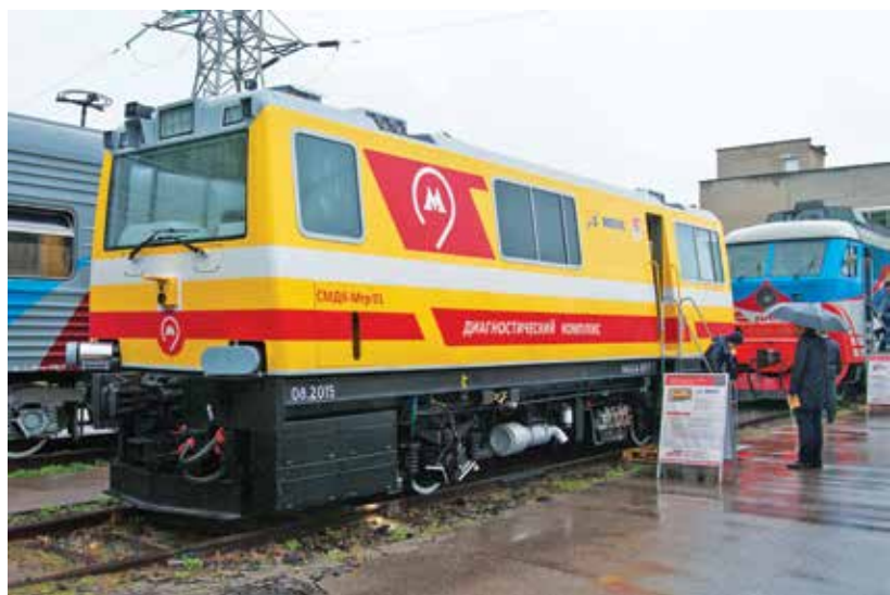
Spalinowy wagon silnikowy serii SMDK-Mtr do badania stanu infrastruktury metra, Szczerbinka k. Moskwy (5.09.2015 r.). Fot. D. Szczukin
