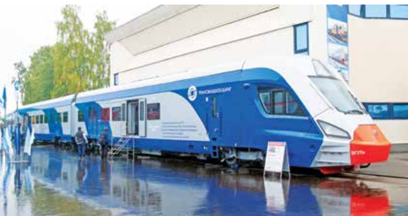
Elektryczny zespół trakcyjny serii EG2Tw (3 kV DC), zbudowany przez fabrykę wagonów w Twerze dla RZD, Szcherbinka k. Moskwy (5.09.2015 r.). Fot. D. Szczukin
