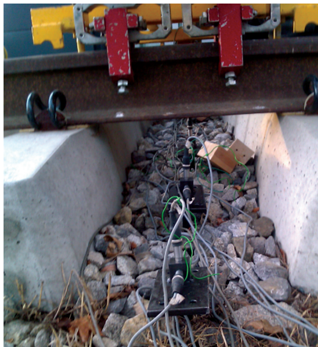
Rys. 5. Czujniki przyspieszeń pionowe i poziome w okienku między podkładami
