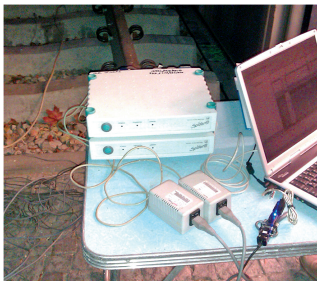
Rys. 6. Stacja rejestrująca SPIDER
