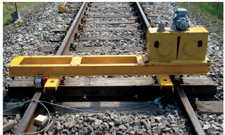
Rys. 13. Wzbudnik bezwładnościowy rotacyjny wraz z silownikami pałkowymi
