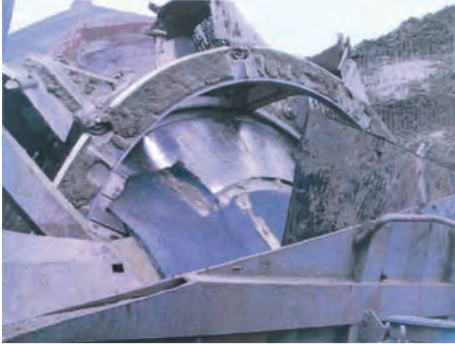
Rys. 1. Koparka KWK 1500. Zniszczona wykładzina zsuwni koła czerpakowego na skutek uderzeń kamieni
