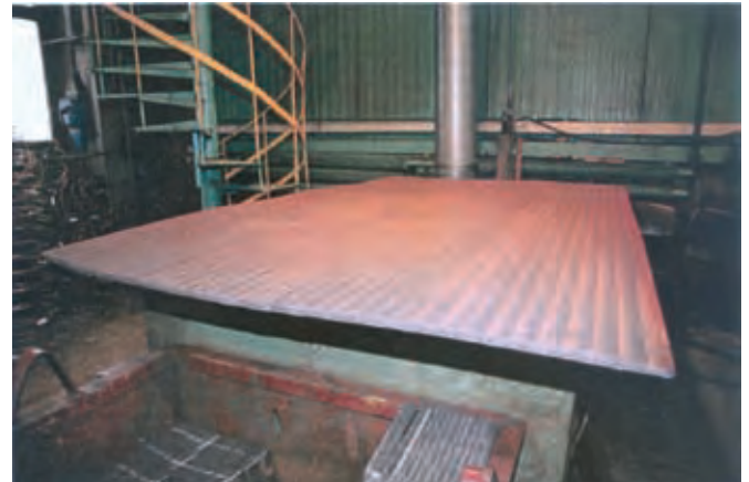
Rys. 8. Blacha wykładzinowa po napawaniu, obok elementy wykładzinowe po cięciu Fig. 8. Lining sheet after padding, next to lining elements after cutting
