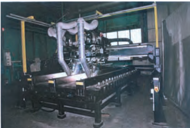
Rys. 7. Proces napawania blach wykładzinowych Fig. 7. The padding process of lining sheets
