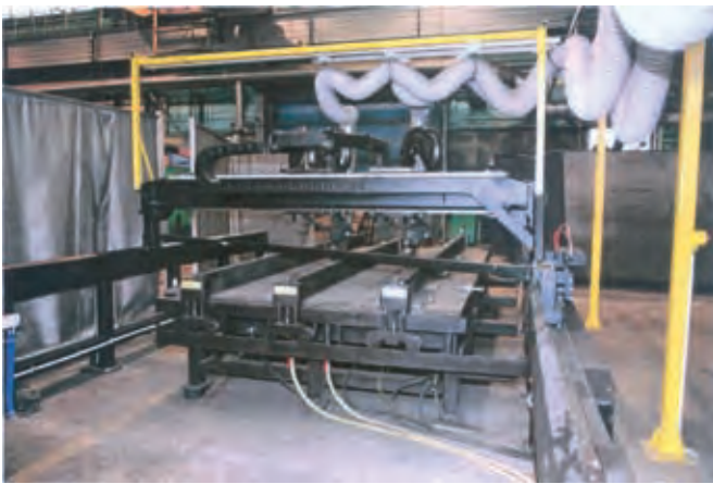
Rys. 6. Zintegrowane stanowisko z ułożonymi blachami wykładzin do napawania Fig. 6. Integrated station with lining sheets for padding
