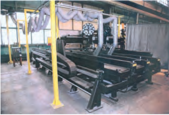
Rys. 5. Zintegrowane stanowisko do napawania i cięcia elementów wykładzinowych Fig. 5. Integrated station for padding and cutting of lining elements
