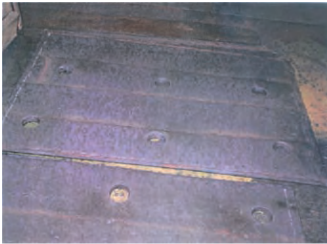
Rys. 9. Gotowe elementy wykładzinowe po napawaniu, cięciu i wykonaniu otworów pod śruby mocujące Fig. 9. Ready lining elements after padding, cutting and making holes for fastening screws
