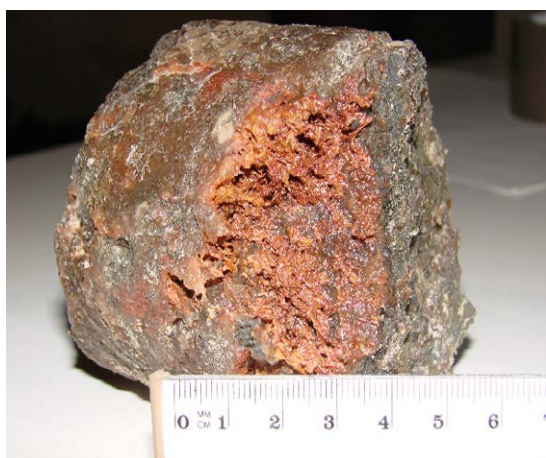
Ryc. 10. Fragment skały zubru brunatnego. Próbkę nr M-34/1451. Po lewej - w skałę widoczne wylugowania po solach K-Mg z nagromadzeniami związków żelaza. Po prawej – skała zubrowa w rozłamie poprzecznym rdzenia.
