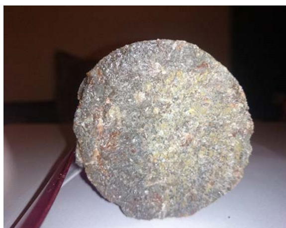
Ryc. 10. Fragment skały zubru brunatnego. Próbkę nr M-34/1451. Po lewej - w skałę widoczne wylugowania po solach K-Mg z nagromadzeniami związków żelaza. Po prawej – skała zubrowa w rozłamie poprzecznym rdzenia.
