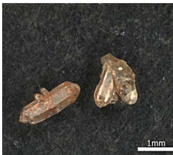
Ryc. 13. Idiomorficznie wykształcone kryształy kwarcu o odcieniu pomarańczowym. Próbką nr M-34/1451. Fig. 13. Idiomorphic, orange quartz crystals. Sample No M-34/1451.
