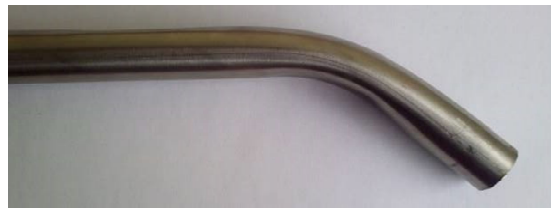
Rys. 8. Rurka gięta na zimno Fig. 8. Cold-bent tube
