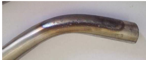
Rys. 9. Rurka gięta z podgrzewaniem laserowym Fig. 9. Tube bent with laser heating
