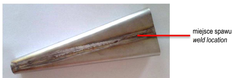
Rys. 11. Półprodukt do badań gięcia – profil stożkowy Fig. 11. Semi-product for bending tests – conical profile
