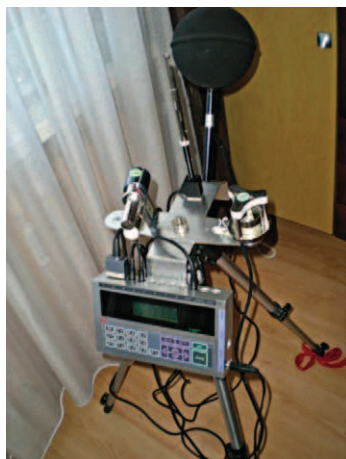
Rys. 2. Cyfrowy miernik klimatu BABUC – pomiar w mieszkaniu na 7 piętrze
