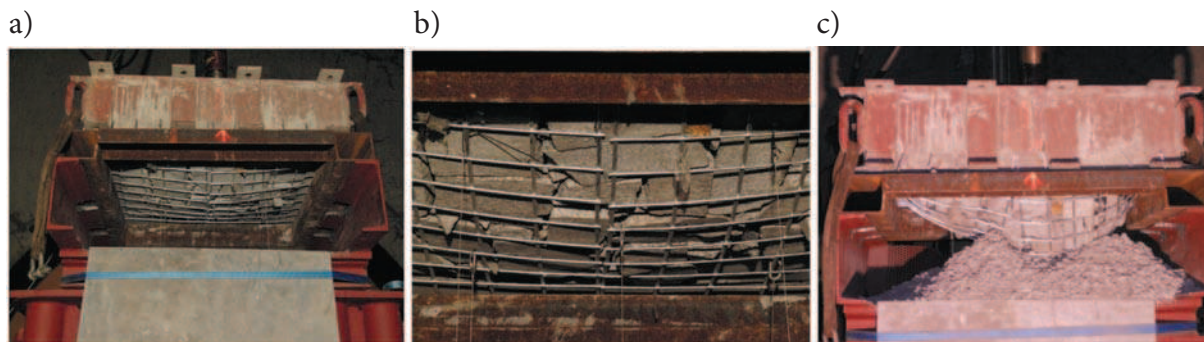
Rys. 10. Siatka zaczepowa (dwie siatki ułożone obok siebie) w stanowisku badawczym a – przed badaniem, b – podczas badania, c – po badaniu Fig. 10. Detent mesh (two meshes adjacent to each other) on the test bench a – before the test b – during the test c – after the test
