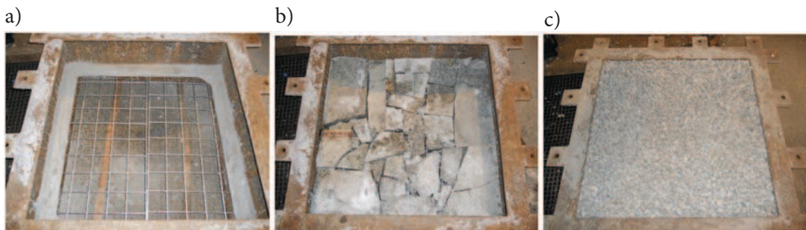
Rys. 3. Kolejne fazy przygotowywania skrzyni do badania siatek zaczepowych
