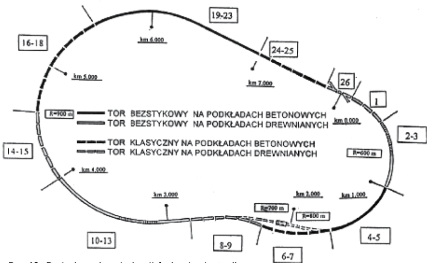
Rys. 10. Rodzaj nawierzchni w II fazie eksploatacji toru doświadczalnego
