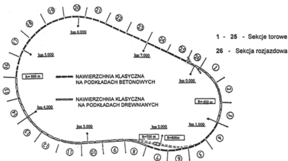
Rys. 9. Rodzaj nawierzchni w I fazie eksploatacji toru doświadczalnego
