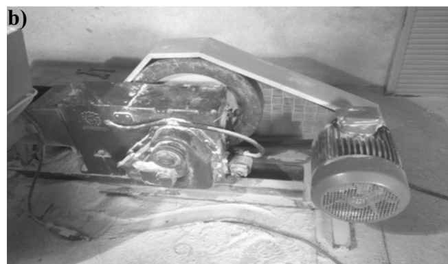
Rys. 1. Stanowisko do badania procesu brykietowania: a) schemat stanowiska: 1 – silnik elektryczny, 2 – koło zamachowe, 3 – zbiornik zasypowy, 4 – tuleja zagęszczająca, 5 – zacisk tulei, 6 – tor stabilizacyjny, 7 – silnik z motoreduktorem, 8 – podajnik ślimakowy, 9 – watomierz, 10 – rejestrator, 11 – komputer PC.
