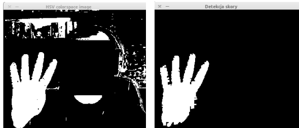
Rys. 2. Dłoń wyodrębniona za pomocą filtrów nałożonych na obraz z kamery internetowej
