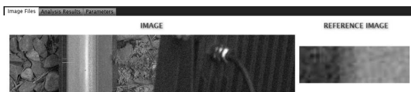
Rys. 9. Wybór obszaru referencyjnego zawierającego fragment głowki szyny i jej otoczenie
