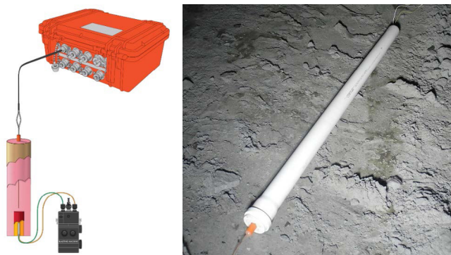
Rys. 4. Zasada pomiaru prób ładunków MW poza otworem strzałowym (z lewej) oraz widok uzbrojonej próby (z prawej) [5]
