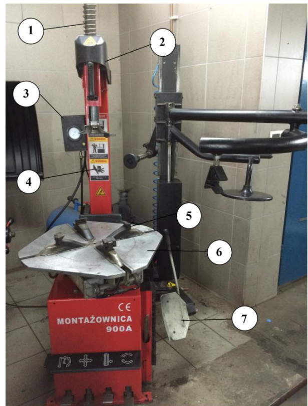
Rys. 1. Główne elementy składowe montażownicy: 1- ramię (suwadło pionowe), 2- suwadło poziome, 3- manometr (pompowania kół), 4- kolumna, 5- szczęki stołu, 6- stół montażowy, 7- zbijak do opon.
