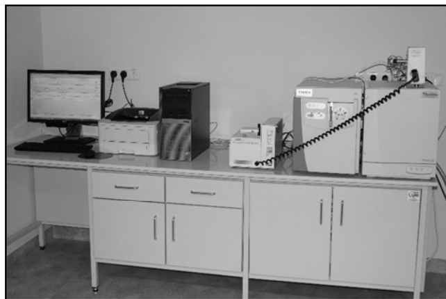
Rys. 2. Chromatograf gazowy sprzężony ze spektrometrem masowym i pirolizerem – Py-GC/MS (fot. S. Żymankowska-Kumon)
