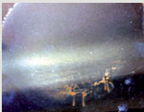
Fot. 10. Wyroszenie związków lotnych na próbce D (tiokol 2)
