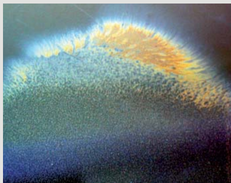
Fot. 7. Wyroszenie związków lotnych na próbce A (butyl)
