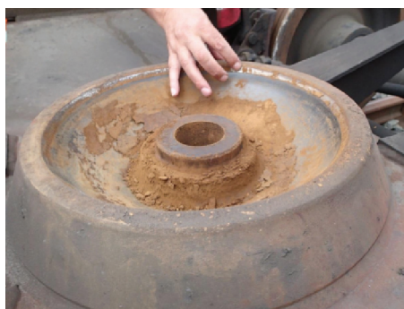
Rys. 1. Widok zużytej wykładziny gniazda skrzytę [2]
