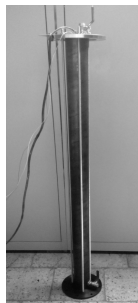
Rys. 2. Układ do wyznaczania współczynnika przejmowania ciepła \alpha cieczy elektroizolacyjnej
