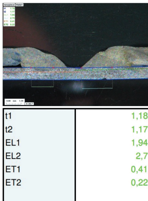
Rys. 8. Fragment raportu z metalograficznego badania zglądów (t1, t2 – grubość materiału bazowego; EL1, EL2 – długości wtopienia w osi cięcia; ET1, ET2 – głębokość wtopienia)
