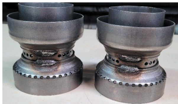
Rys. 1. Końcówki układu wydechowego wykonane na stanowisku automatu spawalniczego (AS-03)
