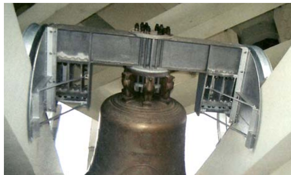
Ryc. 20. Zrealizowany napęd elektromagnetyczny dzwonu Bogurodzica w Licheniu Fig. 20. The electromagnetic drive for Bogurodzica bell in Licheń
