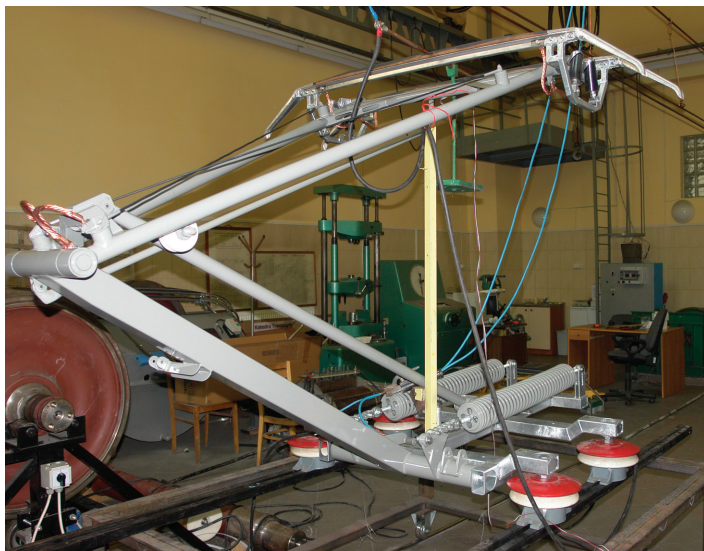
Fot. 1. Odbierak prądu zamontowany na stanowisku badawczym
