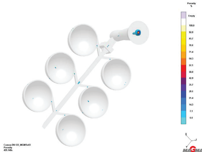
Rys. 4. Rozkład porowatości w odlewach czaszy DN125
