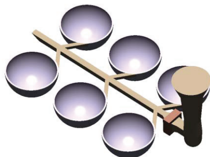
Rys. 1. Rysunek odlewów czaszy DN125 z układem wlewowym
