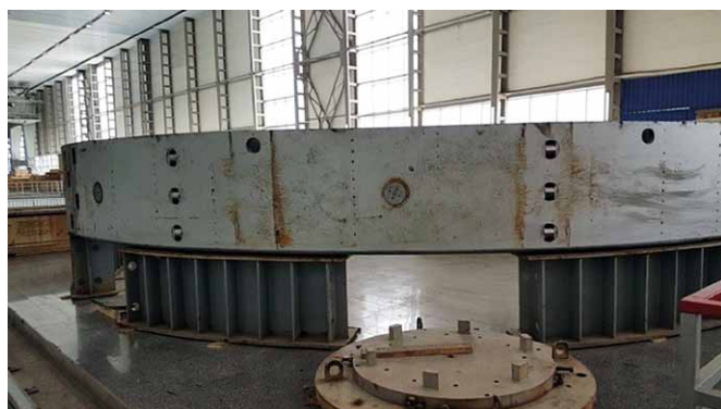
Rys. 8. Pierścień odcinający dopływ wody do aparatu kierowniczego pompo-turbiny w elektrowni szczytowo-pompowej (przed montażem)
