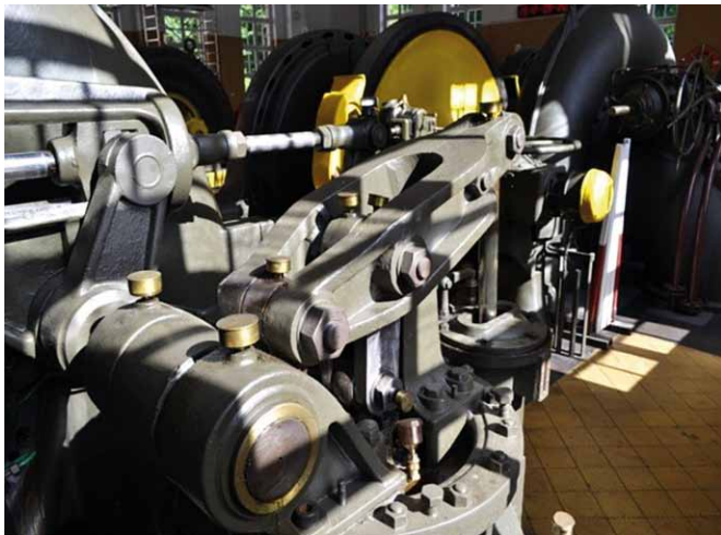
Rys. 13. Zawór odciążający zabudowany na korpusie turbiny Franciszki
