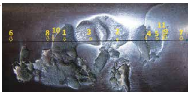
Rys. 4. Wady rzeczywiste squat na powierzchni tocznej szyny
