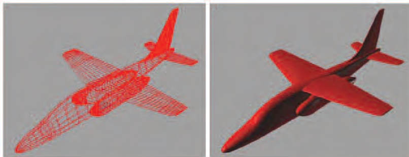
Rys. 16. Zrekonstruowana geometria modelu samolotu do badań flutterowych: siatka głównych krzywych krawędziowych, komputerowy model NURBS
