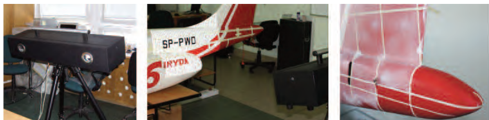
Rys. 2. Skaner optyczny światła strukturalnego; b) przykład pomiaru (rzutowanie prążków na obiekt); c) widok pasków referencyjnych w części ogonowej modelu
