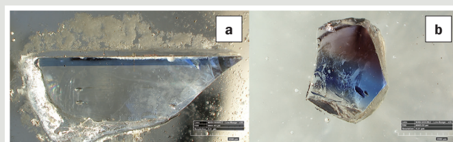
Ryc. 6. Zdjęcia próbek szkieł barwionych warstwowo: (a) błękitne, (b) fioletowe; wykonane mikroskopem optycznym Hirox RH2000.
