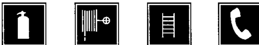
Рис. 5. Указательные знаки: «Огнетушитель», «Пожарный кран», «Пожарная лестница», «Телефон для использования при пожаре»
