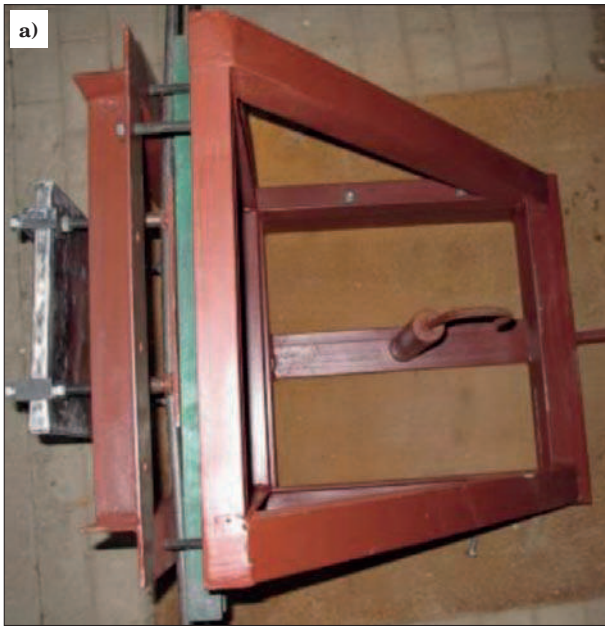
Rys. 19. Rama z zamocowanym panelem (a) oraz sposób montażu panelu (b) Fig. 19. Frame with the fixed panel (a) and the method of assembling the panel (b)
