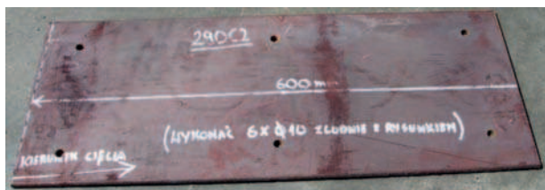
Rys. 6. Element o wymiarach 600 mm × 250 mm × 6,8 mm z blachy NANOS-BA (wytop S290) przeznaczony do konstrukcji przestrzennego panelu
