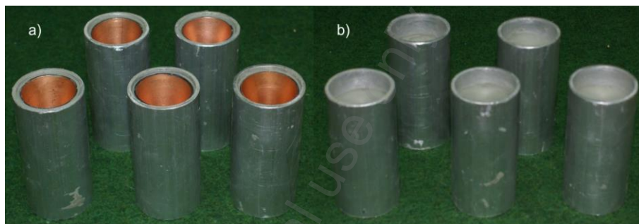
Rys. 9. Ładunki kumulacyjne wypełnione plasteliną (a) widok od strony wkładki kumulacyjnej, (b) widok od strony pobudzenia
