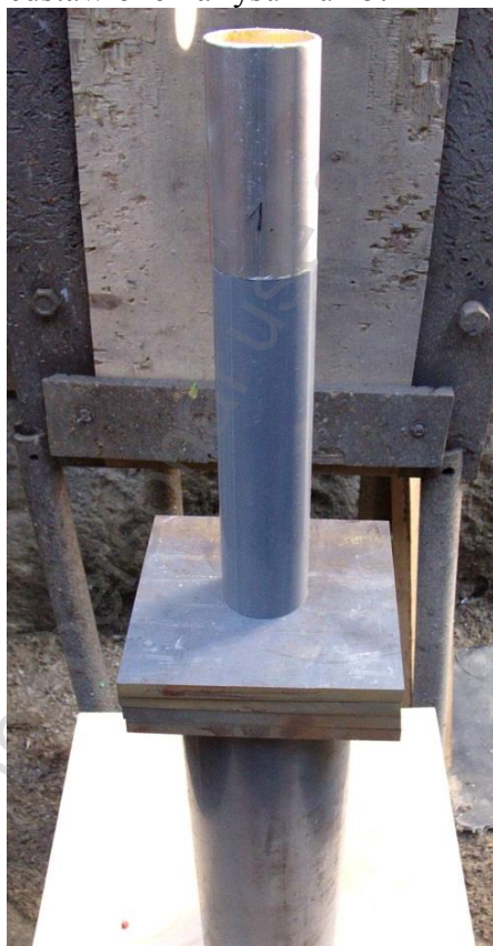
Rys. 15. Zdjęcie stanowiska do rejestracji rentgenowskiej strumienia zdeformowanych ładunków kumulacyjnych
