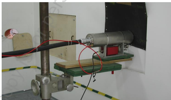
Rys. 7. Promiennik rentgenowski – część zestawu Scandiflash 450
