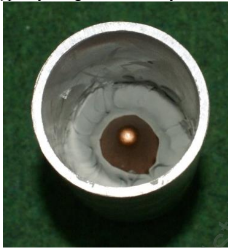
Rys. 8. Ładunek kumulacyjny częściowo wypełniony plasteliną
