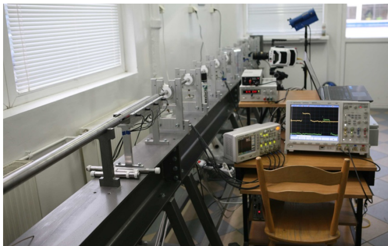
Rys. 10. Pręt Hopkinsona znajdujący się w laboratorium ITS [Moćko 2014] Fig. 10. Hopkinson bar in the ITS laboratory [Moćko 2014]
